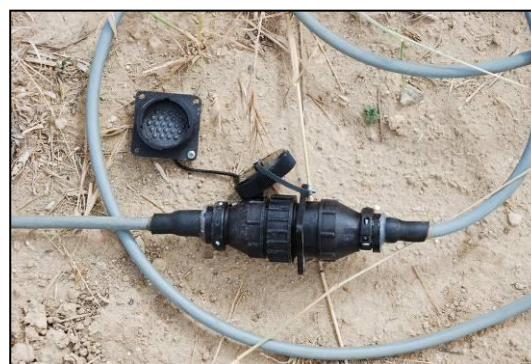
Connessione tra le sezioni di cavi multipolari
