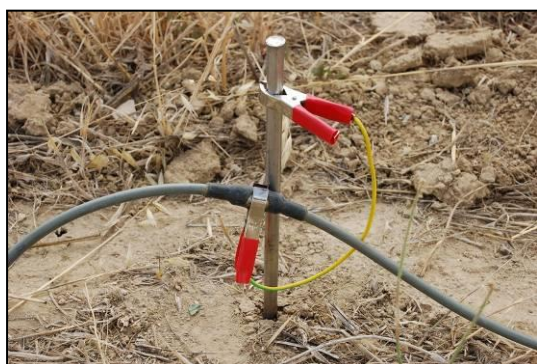
Connessione tra cavi multipolari ed elettrodi
